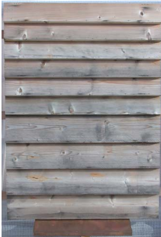
Abb 93 - 96 – Element aus modifizierter, sägerauer gestülpter Fichte (Element 3); einzelne Bretter: 50 bzw. 100 x 20 mm; ost- und westwärts ausgerichtet; keine Oberflächenbehandlung; Bewitterungsdauer: 12 Monate
