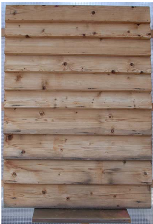
Abb 93 - 96 – Element aus modifizierter, sägerauer gestülpter Fichte (Element 3); einzelne Bretter: 50 bzw. 100 x 20 mm; ost- und westwärts ausgerichtet; keine Oberflächenbehandlung; Bewitterungsdauer: 12 Monate
