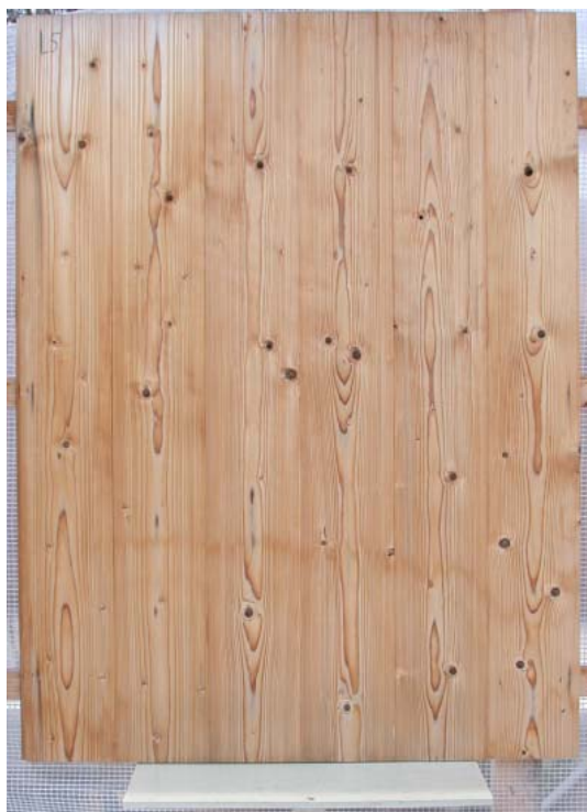
Abb 105 - 108 – Element aus modifizierter, gehobelter bzw. profilierter und stehender Fichtenschalung (Element 6); einzelne Bretter: 100 x 18 mm; ost- und westwärts ausgerichtet; keine Oberflächenbehandlung; Bewitterungsdauer: 12 Monate
