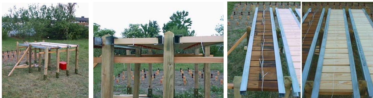
Abb 40, 41, 42, 43 - Ansicht der tragenden Konstruktion (links); Einspannung der "lap-joint"-Proben (Mitte); Draufsicht auf das Probenmaterial bei Bewitterungsstart (rechts)
