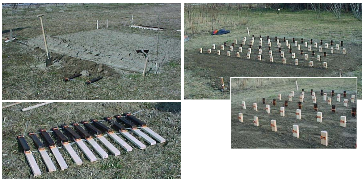
Abb 49, 50, 51 - vorbereitetes Versuchsfeld (oben links); Probenmaterial (unten links); fertig gestellte Versuchsanordnung (rechts)
