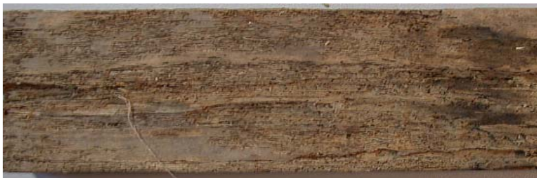
Abb 52 - Erdkontaktproben mit Bewertungsziffern 0 (kein Angriff) - 3 (starker Angriff)
