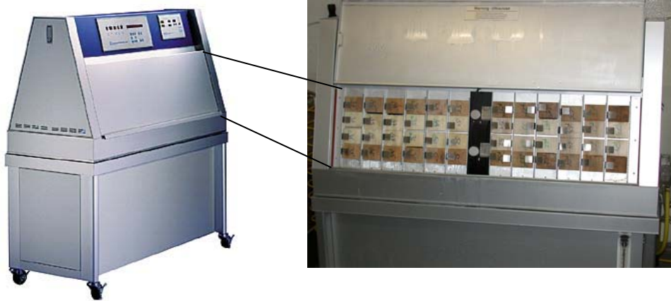
Abb 54 - QUV - Weathering Tester mit eingespannten Proben während der künstlichen Bewitterung
