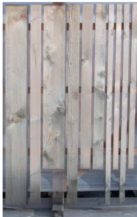
Abb 73 - 76 – Elemente aus unbehandelter und sägerauer bzw. gehobelter Fichte (Element 4); ost- und westwärts ausgerichtet; Bewitterungsdauer: 12 Monate
