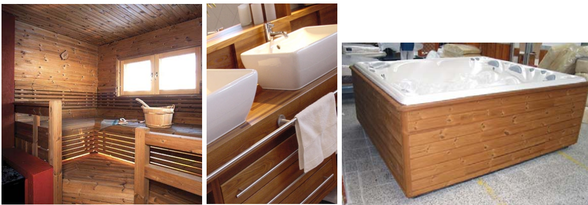
Abb 33, 34, 35 - Sauna aus Kiefer und Espe, Thermowood / FI (links); Badezimmer, Esche, Thermoholz / A (Mitte); Badebeckenkonstruktionen und Verschalung, Kiefer, Lunawood / FI (rechts)
