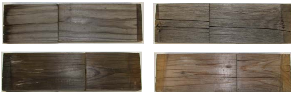
Abb 45 - modifiziertes und unbehandeltes Probenmaterial nach einem Jahr Bewitterung
