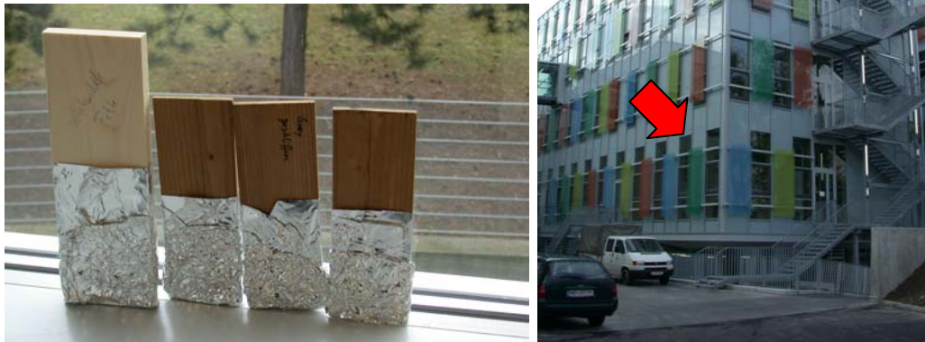
Abb 62 & 63 - Ausschnitt der Versuchsanordnung (links) für die Untersuchung der Farbveränderungen im Innenbereich hinter einer Glasfassade des Schwackhöfer-Hauses / Universität für Bodenkultur Wien (rechts)
