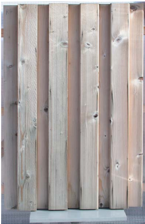
Abb 101 - 104 – Element aus modifizierter, sägerauer und stehender Fichtenschalung (Element 5); einzelne Bretter: 80 x 20 mm; ost- und westwärts ausgerichtet; in der Schalung vorne liegenden Bretter; keine Oberflächenbehandlung; Bewitterungsdauer: 12 Monate
