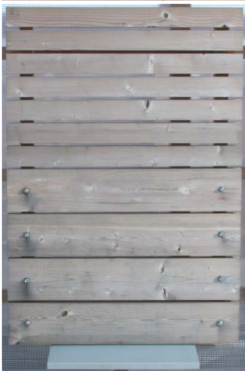
Abb 87 - 90 – Elemente aus modifizierter und sägerauer Fichte (Element 2); einzelne Bretter: 50 x 20 bzw. 100 x 20 mm; ost- und westwärts ausgerichtet; keine Oberflächenbehandlung; Bewitterungsdauer: 12
