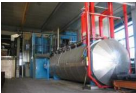
Abb 11 - Produktionsanlage von "Wärmestabilisiertem Holz"
