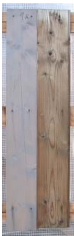
Abb 77 - 80 – Elemente aus unbehandelter und gehobelter Fichte (Element 8); ost- und westwärts ausgerichtet; Oberflächenbehandlung: Dünnschichtlasur mit beschleunigter chemischer Vergrauung und Alkyd-Acrylatharz- Beschichtung (grau gestrichene Oberfläche); Bewitterungsdauer: 12 Monate
