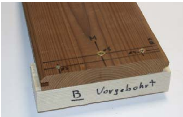
Abb 141 - Beispiel der Probenvariante B mit dem SPAX-S (vorgebohrt) als Befestigungsmittel
