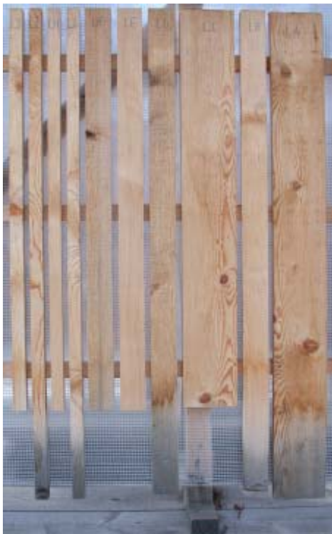
Abb 73 - 76 – Elemente aus unbehandelter und sägerauer bzw. gehobelter Fichte (Element 4); ost- und westwärts ausgerichtet; Bewitterungsdauer: 12 Monate
