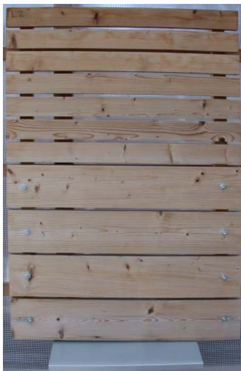
Abb 87 - 90 – Elemente aus modifizierter und sägerauer Fichte (Element 2); einzelne Bretter: 50 x 20 bzw. 100 x 20 mm; ost- und westwärts ausgerichtet; keine Oberflächenbehandlung; Bewitterungsdauer: 12
