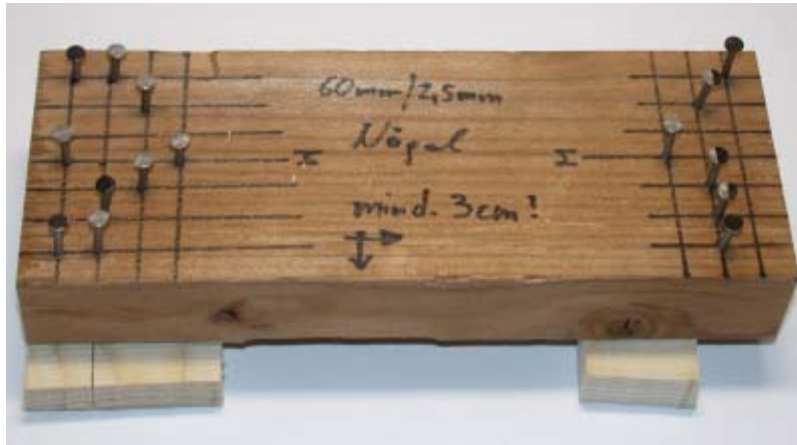
Abb 136 & 137 - Ermittlung des Mindeststrandabstandes von Drahtstiften (60/2,5) bei Brettern (85 x 30 mm) (links) und bei Latten (40 x 25 mm) (rechts)
