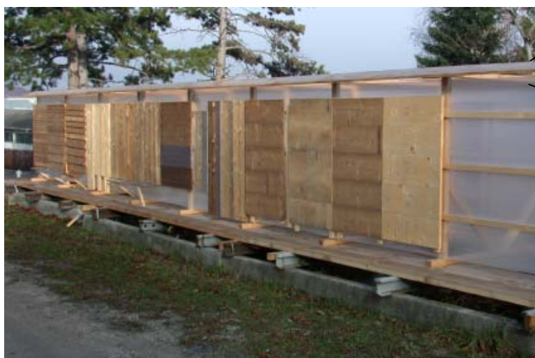
Abb 68 - fertig gestellte Fassadenelemente mit kleinem Vordach
