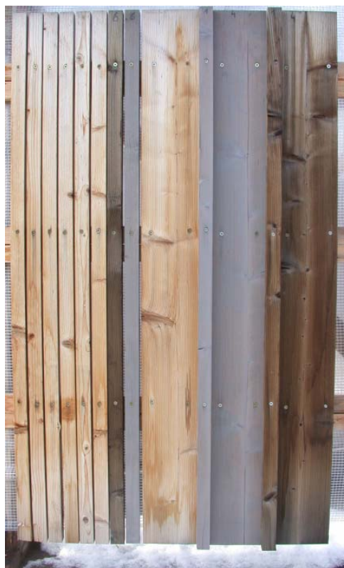
Abb 119 - 122 – Element aus modifizierter und sägerauer Decklattenschalung (Element 9); einzelne Bretter bzw. Latten: 100 x 20 mm und 20 x 20 mm; ost- und westwärts ausgerichtet; Oberflächenbehandlung: keine (hell), Alkyd-Acrylatharz - Beschichtung (grau), Transparent-Effekt-Imprägnierungsmittel (Dünnschichtlasur) zur chemischen Vergrauung (dunkel); Bewitterungsdauer: 12 Monate
