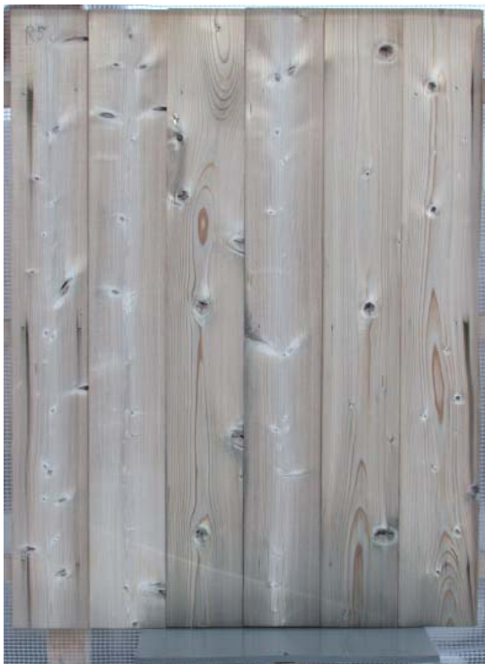
Abb 105 - 108 – Element aus modifizierter, gehobelter bzw. profilierter und stehender Fichtenschalung (Element 6); einzelne Bretter: 100 x 18 mm; ost- und westwärts ausgerichtet; keine Oberflächenbehandlung; Bewitterungsdauer: 12 Monate
