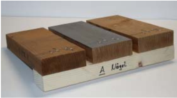
Abb 140 - Beispiel der Probenvariante A mit dem Drahtstifte als Befestigungsmittel
