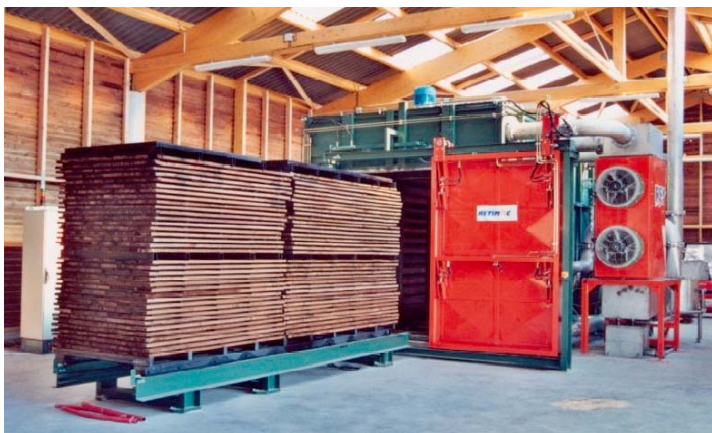
Abb 8 - Produktionsanlage von Retified Wood® Perdure® Wood (dauerhaftes Holz)
