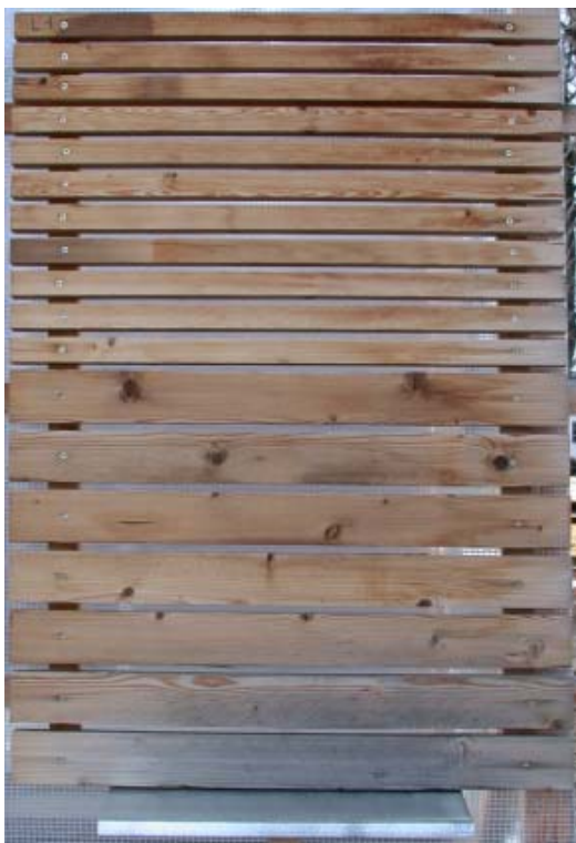
Abb 83 - 86 – Elemente aus modifizierter und sägerauer Fichte (Element 1); einzelne Leisten oder Bretter: 20 x 20 bzw. 50 x 20 mm; ost- und westwärts ausgerichtet; keine Oberflächenbehandlung; Bewitterungsdauer: 12
