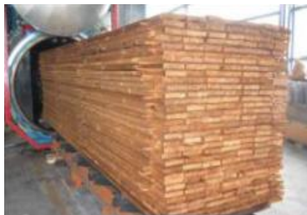
Abb 11 - Produktionsanlage von "Wärmestabilisiertem Holz"
