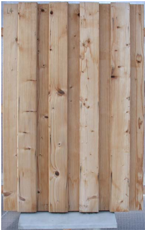
Abb 101 - 104 – Element aus modifizierter, sägerauer und stehender Fichtenschalung (Element 5); einzelne Bretter: 80 x 20 mm; ost- und westwärts ausgerichtet; in der Schalung vorne liegenden Bretter; keine Oberflächenbehandlung; Bewitterungsdauer: 12 Monate
