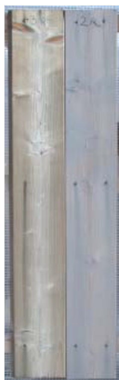
Abb 77 - 80 – Elemente aus unbehandelter und gehobelter Fichte (Element 8); ost- und westwärts ausgerichtet; Oberflächenbehandlung: Dünnschichtlasur mit beschleunigter chemischer Vergrauung und Alkyd-Acrylatharz- Beschichtung (grau gestrichene Oberfläche); Bewitterungsdauer: 12 Monate
