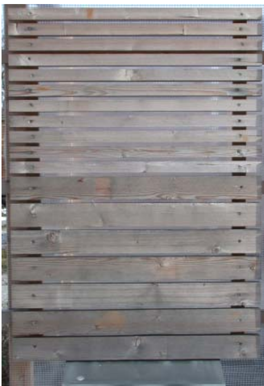
Abb 83 - 86 – Elemente aus modifizierter und sägerauer Fichte (Element 1); einzelne Leisten oder Bretter: 20 x 20 bzw. 50 x 20 mm; ost- und westwärts ausgerichtet; keine Oberflächenbehandlung; Bewitterungsdauer: 12
