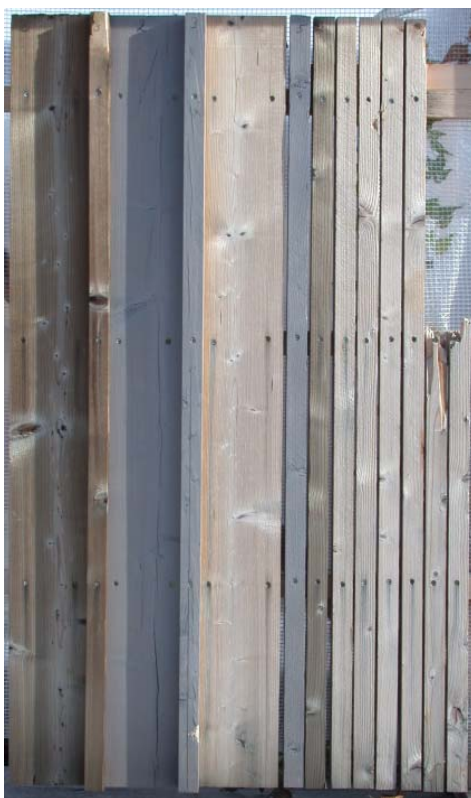
Abb 119 - 122 – Element aus modifizierter und sägerauer Decklattenschalung (Element 9); einzelne Bretter bzw. Latten: 100 x 20 mm und 20 x 20 mm; ost- und westwärts ausgerichtet; Oberflächenbehandlung: keine (hell), Alkyd-Acrylatharz - Beschichtung (grau), Transparent-Effekt-Imprägnierungsmittel (Dünnschichtlasur) zur chemischen Vergrauung (dunkel); Bewitterungsdauer: 12 Monate
