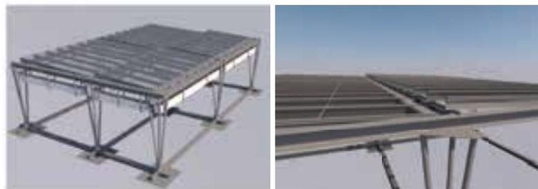
Abbildung 41: PV-Dachgarten – Erweiterungsmodul mit/ohne Blumentrögen
