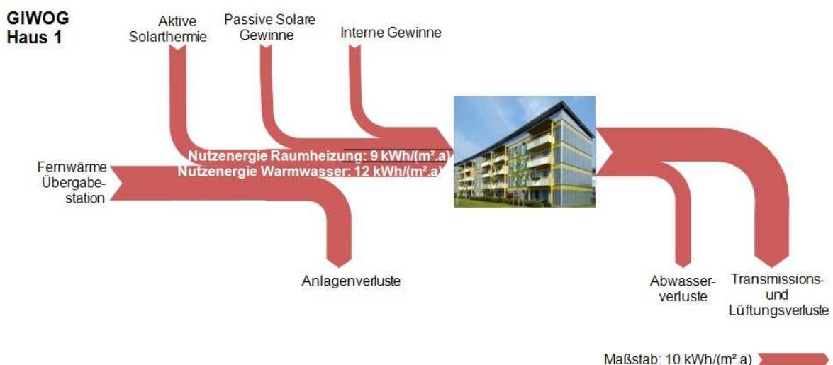
Abbildung 8: Sankey-Diagramm – Darstellung der Wärmeflüsse des Passivhauses GIWOG Haus 1 pro Bruttogeschoßfläche.
